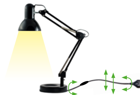
De lamp is niet alleen aangesloten maar brandt ook: er is ook een magnetisch veld
